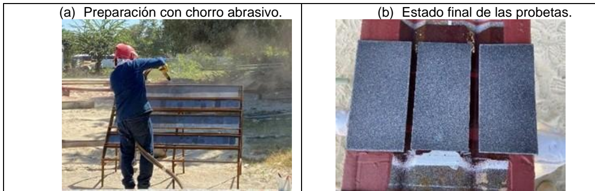
Ilustración 1. Preparación superficial mediante chorro abrasivo
