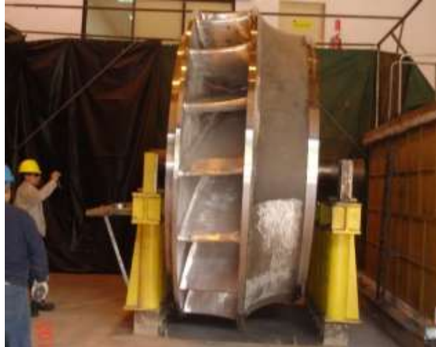
Figura 5. Balanceo estático de la pieza a restaurar.
