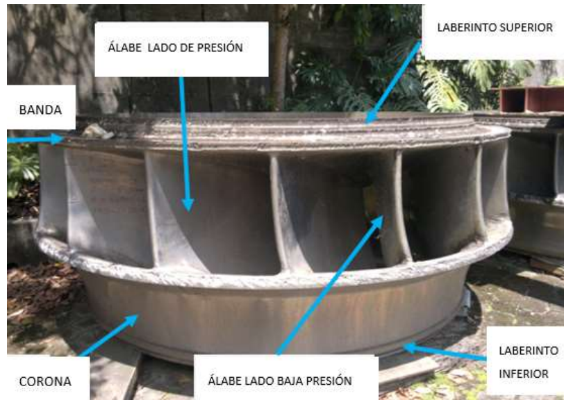
Figura 2. Partes principales del rodete de una turbina tipo Francis.
