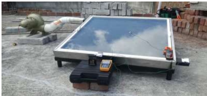
Figura 4. Recolección de datos de temperaturas en diferentes puntos del módulo (Fuente: Autores)
