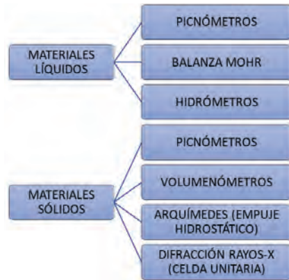
Figura 1. Esquema de métodos comunes de determinación de densidad
