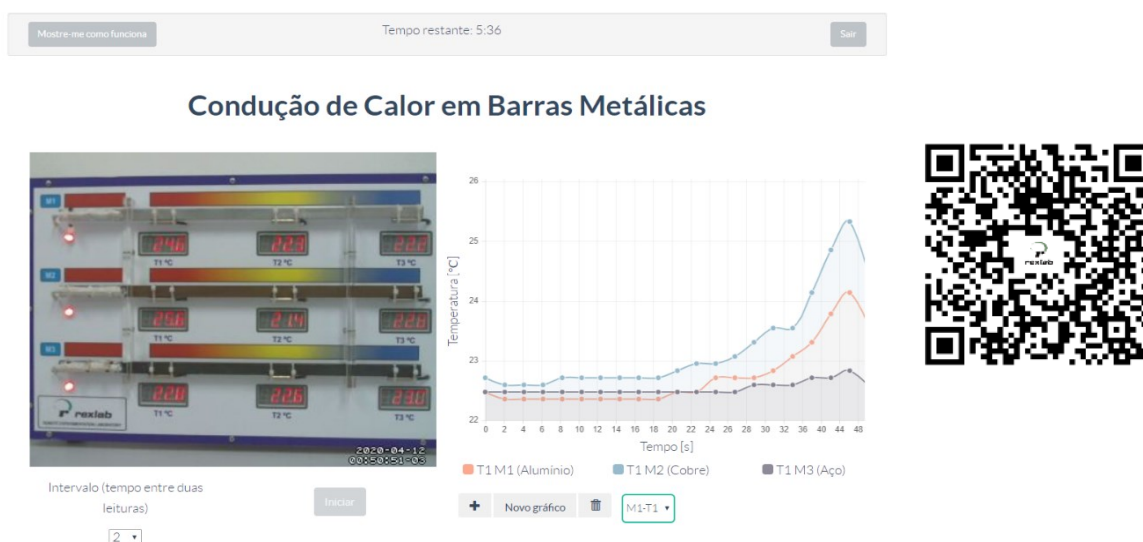
Fig. 7 – Laboratório Remoto, Condução de Calor em Barras Metálicas. Fonte: < http://relle.ufsc.br/labs/13 >.
