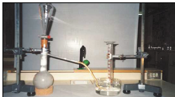
Foto 3. Montaje para la determinación de la pureza del carburo de calcio
