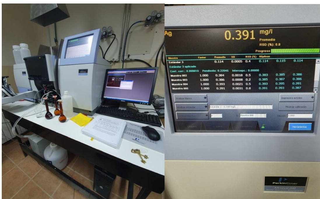
Fig. 4. Concentraciones de Fe y Ag medidas en Espectrofotómetro de absorción atómica Perkin Elmer AAnalyst 200
