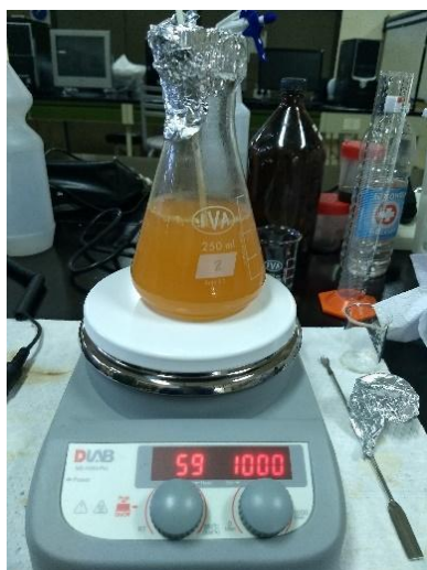
Fig. 1. Solución de almidón, cloruro férrico y sulfato férrico en atmósfera de nitrógeno
