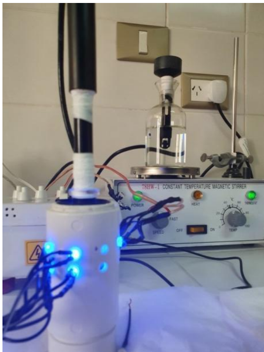
Fig. 7: Fitolizador LED para el análisis del consumo de oxígeno en reacciones fotosensibilizadas
