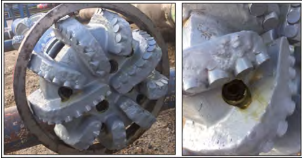
Figura 29. Diseño de moedor híbrido para molienda de la ventana con formación abrasiva detrás.
