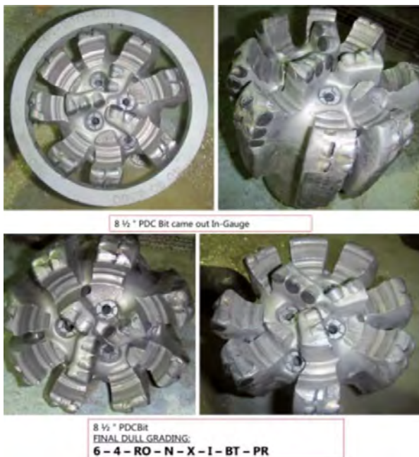
Figura 6. Desgaste de broca PDC que perforó 54 ft de una formación altamente abrasiva y resistente.
