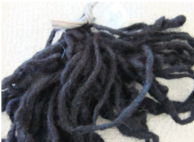
FIGURA 8. Lana teñida en laboratorio mediante el método del baño de hidrosulfito (Fotografía: Sergio Franco Maass, 2017).
