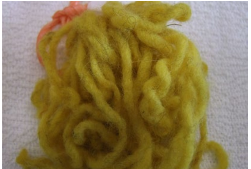
FIGURA 12. Lana sin morder teñida en laboratorio con pétalos y cabezuelas de cempasúchil (Fotografía: Sergio Franco Maass, 2017).
