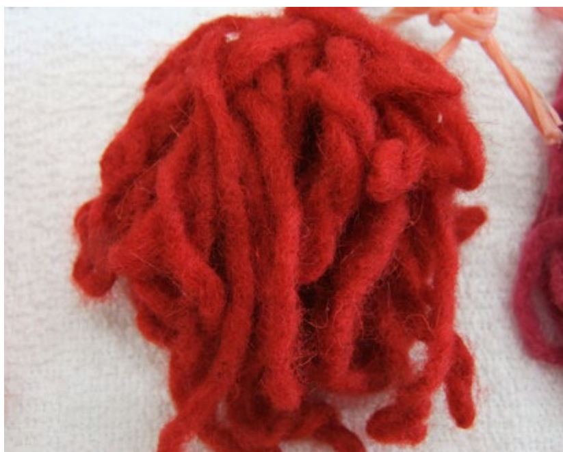
FIGURA 9. Lana sin morder teñida en laboratorio con grana cochinilla en medio ácido (Fotografía: Sergio Franco Maass, 2017).
