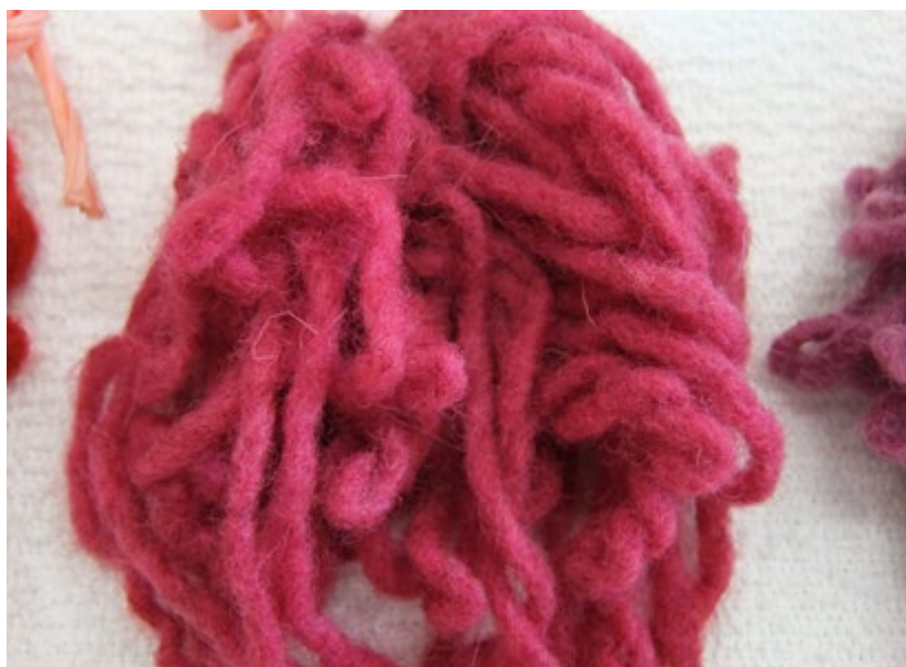
FIGURA 10. Lana mordida con alumbre teñida en laboratorio con grana cochinilla en medio ácido (Fotografía: Sergio Franco Maass, 2017).
