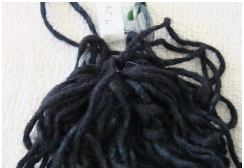
FIGURA 7. Lana teñida en laboratorio mediante el método de fermentación de orina humana (Fotografía: Sergio Franco Maass, 2017).
