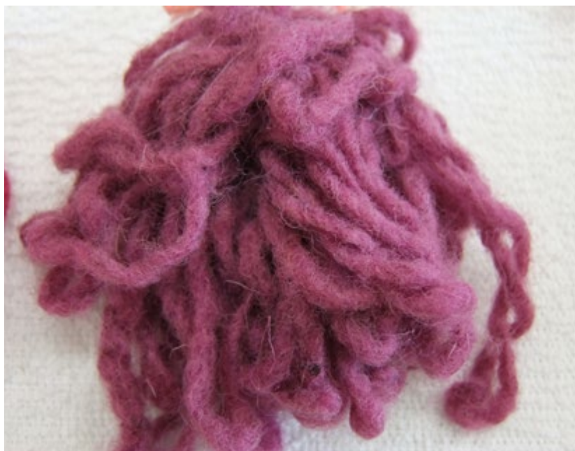
FIGURA 11. Lana mordida con dicromato de potasio teñida en laboratorio con grana cochinilla en medio ácido (Fotografía: Sergio Franco Maass, 2017).
