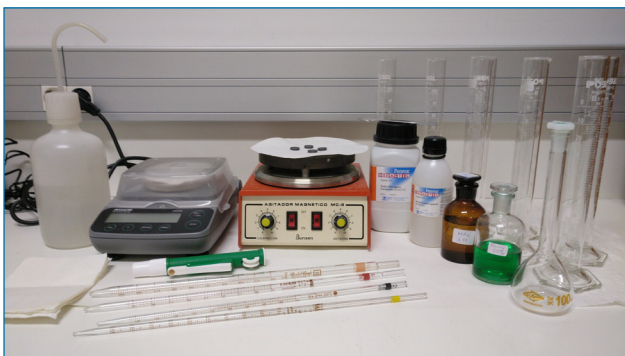
Figura 1. Material utilizado: balanza, agitador magnético, ácido acético, hidrogenocarbonato de sodio, lavavajillas, probetas, pipetas graduadas, matraz aforado, succionador, espátula, papel de filtro
