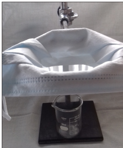
Figura 15. Comprobación de la impermeabilidad de una mascarilla
