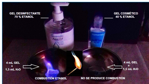
Figura 10. Prueba de combustión de hidrogeles alcohólicos
