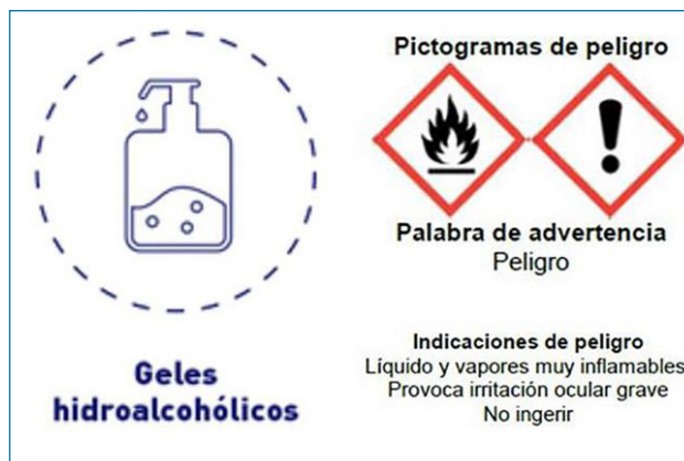
Figura 9. Pictogramas de peligro que deben llevar en el etiquetado los geles hidroalcohólicos antisépticos (inflamable y peligroso para la salud), según el reglamento CLP
