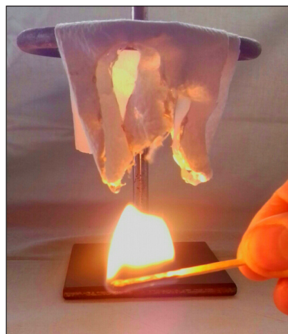
Figura 16. Comprobación de la incombustibilidad de un filtro
