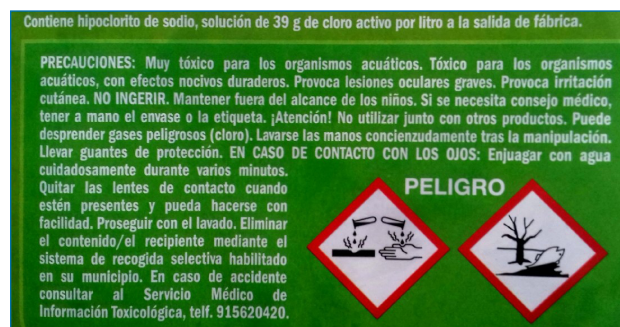
Figura 11. Etiqueta con indicaciones y pictogramas de peligro de la lejía doméstica: corrosiva y peligrosa para el medio ambiente
