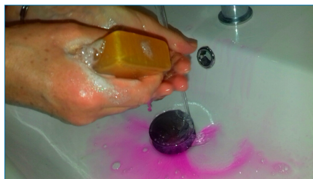
Figura 8. Coloración violeta de la fenolftaleína causada por la hidrólisis de las sales neutras del jabón
