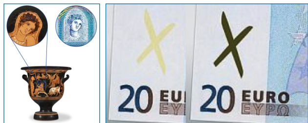
Figura 5. Izquierda: Ventana holográfica transparente incorporada en las tiras reflectantes (billete de 20 euros), mostrando el retrato del personaje mitológico Europa, que puede verse en ambos caras del billete. Derecha: Marca realizada con rotulador con base de lugol, sobre papel rico en amilopectina (no deja marca coloreada) y sobre papel normal de amilosa (deja marca oscura)
