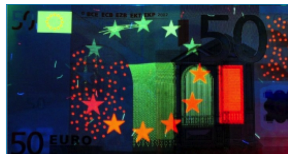
Figura 12. Billete de 50 euros bajo radiación ultravioleta, donde se aprecia el rojo, verde y anaranjado, fruto de los complejos de europio, terbio y mezcla de ambos, respectivamente
