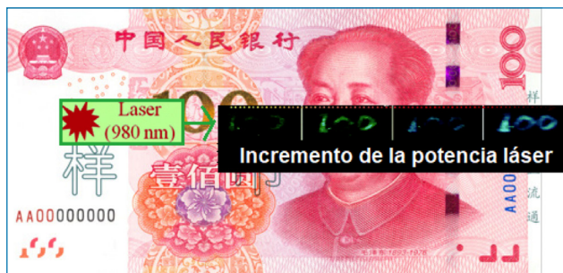
Figura 13. Billeto de 100 yuan o remimbi, impreso en zonas estratégicas con tintas de conversión ascendente de fotones ( upconversion ), capaces de emitir radiación bajo excitación infrarroja
