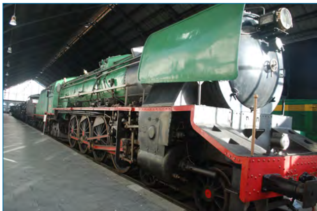
Figura 12. Locomotora tipo Confederación 242, de diseño español, es la más potente construida en serie en Europa. Se aprecian los reflectores alimentados por un generador eléctrico movido por vapor Foto: JAMP 02/05/2018
