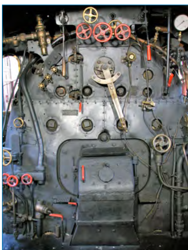
Figura 5. Frontal de la cabina (marquesina) de una Mikado. Abajo y centro se aprecia la puerta del hogar por la que en el fogonero paleaba el carbón o prendía el fuel por el "método del trapo encendido". Foto: JAMP 02/05/2018
