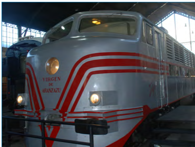
Figura 7. Tren Talgo II ( Tren Articulado Ligero Goicoechea Oriol ). Está construido con duraluminio, aleación de aluminio, silicio y otros metales que mejoran sus propiedades mecánicas. Aunque su diseño es español, de Alejandro Goicoechea, está construido en EE. UU. en 1950. Foto: JAMP 02/05/2018
