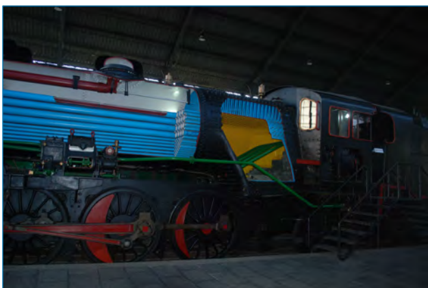
Figura 4. Locomotora 141 "Mikado" seccionada. Se muestra el hogar (1) donde se quema el combustible y la caldera donde produce el vapor que es recogido por el domo (2) y conducido al motor. Se aprecia también el inyector para reposición de agua en la caldera (3). Foto: JAMP 02/05/2018
