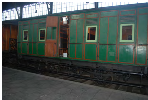
Figura 10. Coche de viajeros de tercera clase de principios del siglo xx. Se alumbraba con tres candiles de aceite para todo el coche, que se encendían en la estación por el exterior y desde el techo del vehículo. Como novedad reseñable lleva cristales en las ventanillas. La restauración de que ha sido objeto contiene errores. Foto: JAMP 02/05/2018
