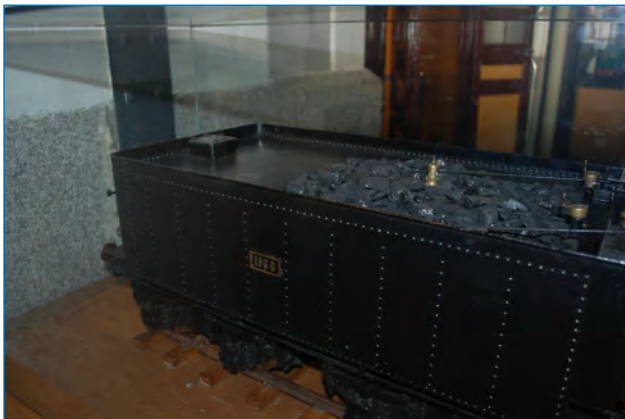
Figura 3. Modelo a 1:10 de un ténder, se observa el carbón y la compuerta de recarga de agua. Foto: JAMPO2/05/2018
