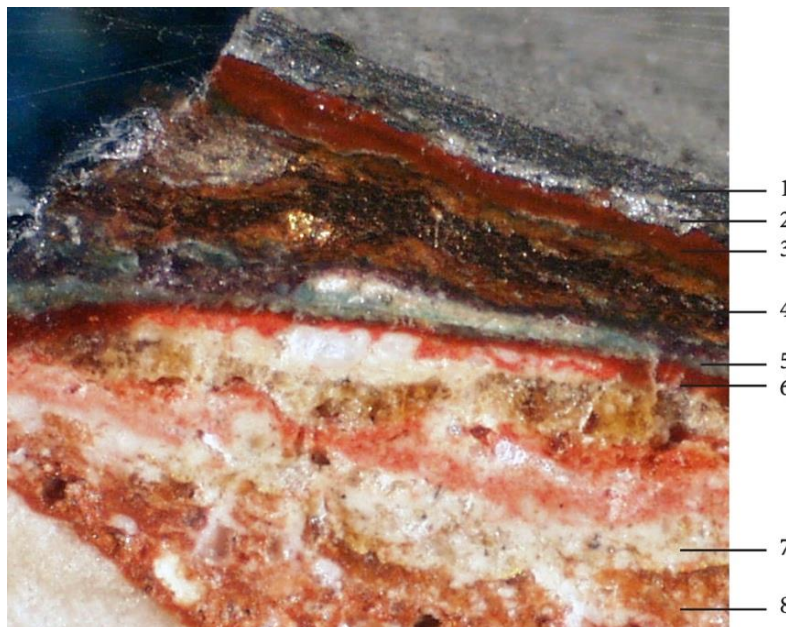
Fig. 28: Estratigrafia da amostra 7 com enumeração das camadas. Visualização de pequenas partículas brilhantes com um tom prateado. Possibilidade de existir folha de prata na presente amostra. Capela de São Bartolomeu, Aveiro. Foto: NR.
