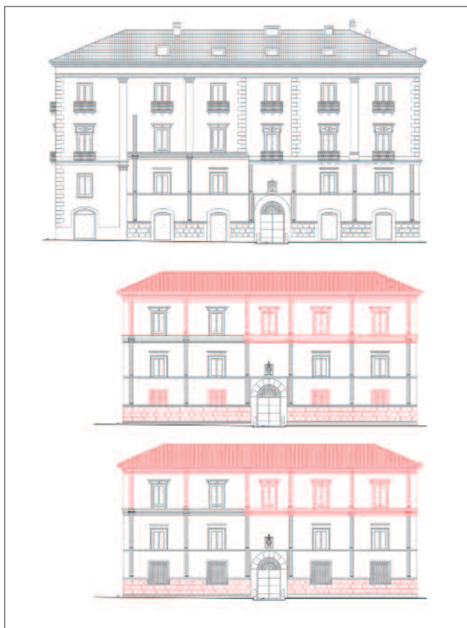
Fig. 11. Cosenza. Palazzo di Pompeo Sersale 1592, riproduzione schematica del prospetto attuale e ipotesi ricostruttiva di due possibili configurazioni dell'impianto originario: la prima con le finestre al piano terreno impostate sulla linea continua del cordolo superiore della zoccolatura; il secondo con le stesse finestre impostate sulla spezzata del cordolo, secondo il motivo presente sul fianco destro dell'edificio (disegni di B. Purcheddu, elaborazione dell'autore).
