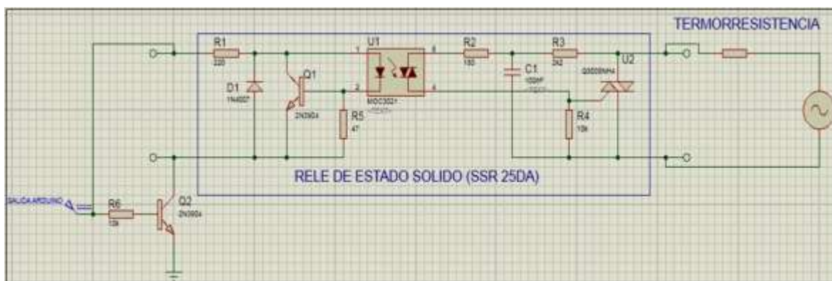
Figura 8: Circuito del módulo de potencia.
