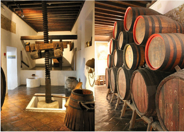
Prensa de viga para vino y bocoyes en solera. Museo Unicaja de Artes y Costumbres Populares de Málaga.
