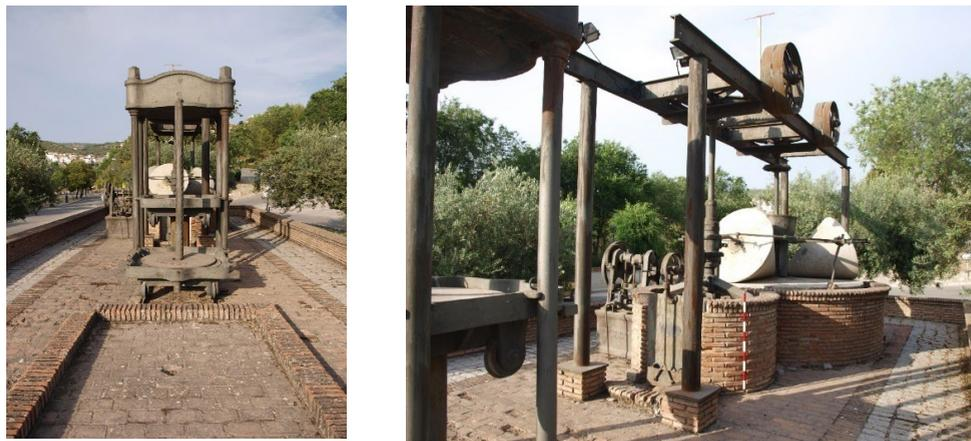
**Figura 8-9.** Molino y prensa hidráulica de la fábrica de aceite que existió en El Paseo esquina Juan de Carrión. (Monumento al Olivo). Se observan la prensa, los rulos y el alfarje, vagoneta, así como los mecanismos de transmisión...
