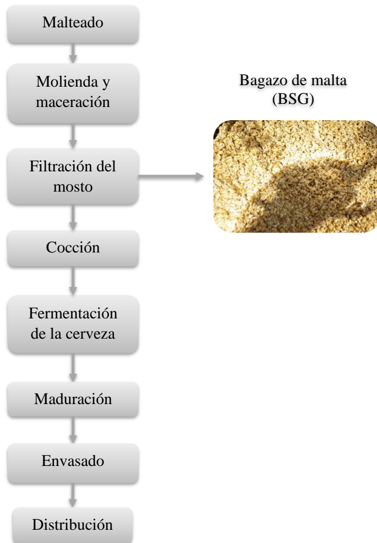
Figura 1. Esquema del proceso de obtención de cerveza. Fuente: adaptado de [2] Kunze, 2014.
