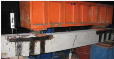
Figura 3. Reforzamiento externo a vigas con laminados de PRFC. Fuente: [40].
