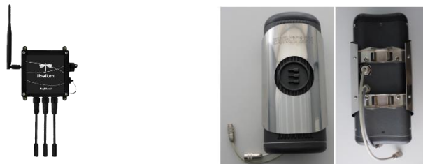
Figura 4. Dispositivos IoT seleccionados en la solución propuesta. 3-a Waspote Plug & Sense [15] (izquierda); ReliaSENS 18-12 [16] (derecha)
