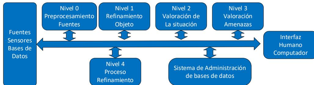
**Figura 6:** Modelo propuesto en la arquitectura JDL
