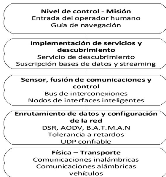
**Figura 4:** Modelo por capas del sistema de comunicaciones
