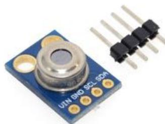
**Figura 4.** Sensor de temperatura infrarrojo MLX90614.
