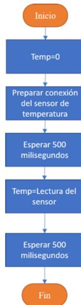
**Figura 12.** Diagrama de flujo función temperatura.
