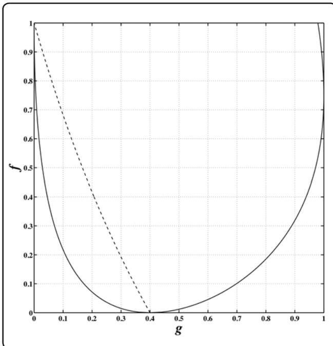
**Figura 2. Diagrama de bifurcación del sistema BVAM, sin difusión, en el plano  $(g, f)$ , para  $h = -2.5$ ,  $C = 0$  y  $\eta = 0.5$ . La línea continua es una bifurcación de Hopf y la línea punteada es una bifurcación de silla-nodo. Al cruzar la línea, el sistema pasa de tener un ciclo límite en la región izquierda a ser biestable en la región derecha.**
