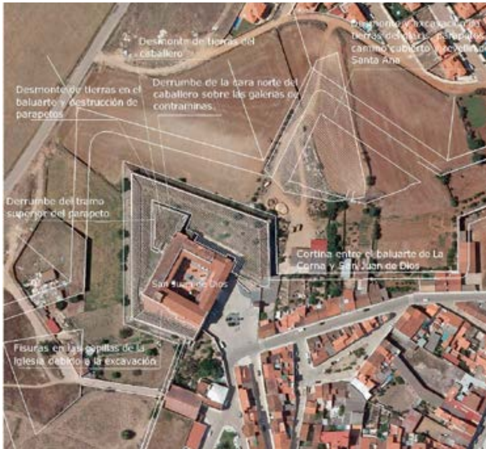
Nº 42.- Excavaciones y desmontes. (J.M. Vázquez).
