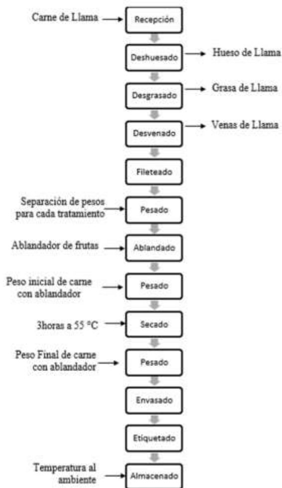
Figura 2: Diagrama de proceso para la elaboración de carne deshidratada de llama
