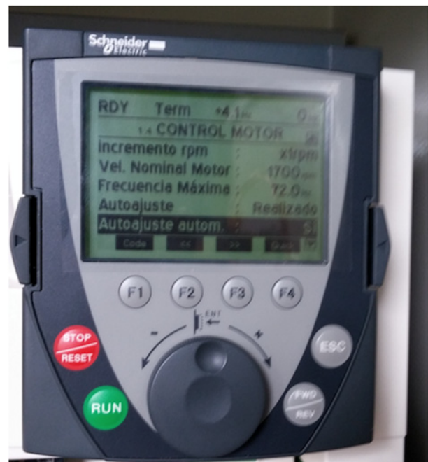
Figura 5. Configuración de parámetros del motor a controlar [Velocidad nominal del motor, frecuencia máxima y autoajuste]
