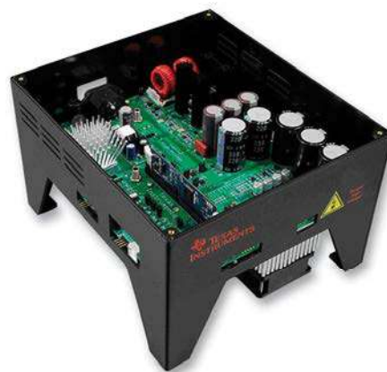
Fig. 1 Maqueta hardware del KIT de desarrollo HVMotorCtrlt v1.7/v2.0 de Texas Instruments
