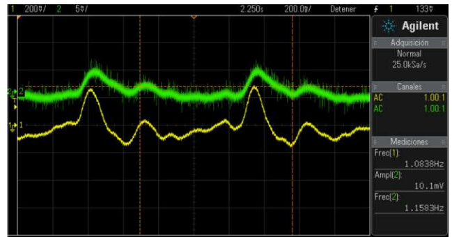
Fig. 7. Señal de pulso en el divisor resistivo (verde) y a la salida de la etapa amplificadora (amarillo)
