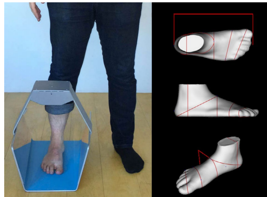
Figura 3 Sistema de captura 3D del pie DOMEscan/IBV.
