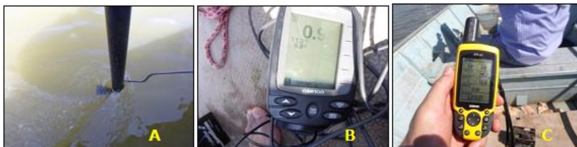
Figura 3: Sensor submerso para captação de dados (A); resultado fornecido no visor do sonar (B); metragem, longitude e latitude sendo captada pelo gps (C)
