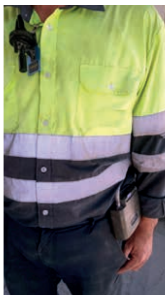
Figura 5: Equipo de medición compuesto por bomba de muestreo, sistema de clasificación (muestreador), elemento de retención (filtro) y medidor de caudal (caudalímetro).
