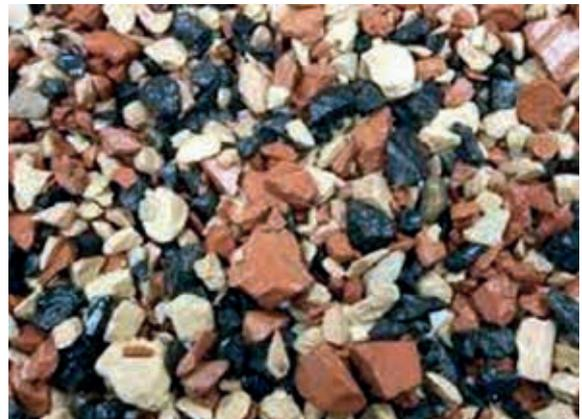
Para su fabricación se utilizan arcillas de alta alúmina, con contenido en Fe<sub>2</sub>O<sub>3</sub> entre el 2% y el 5%.
