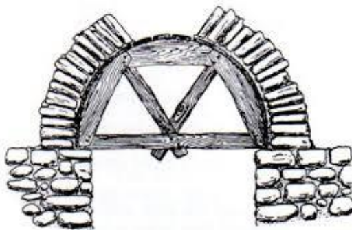
fg.52) Detalle de la cimbra de madera utilizada para la construcción del arco
