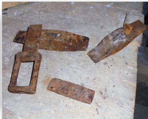
Diferentes útiles metálicos que se emplean en el tallado de las piedras del molino, y que por su desgaste tienen que ser sometidos a un proceso de afilado.
