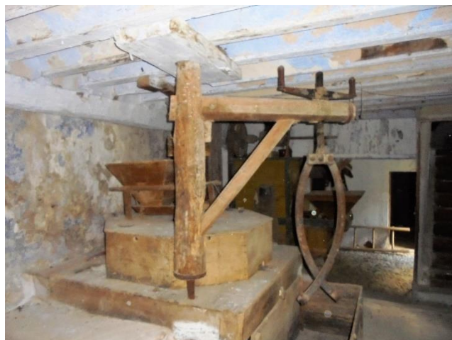
fg.11) Forjado con vigas de madera. Sala ubicación molino harinero en edificio principal.
