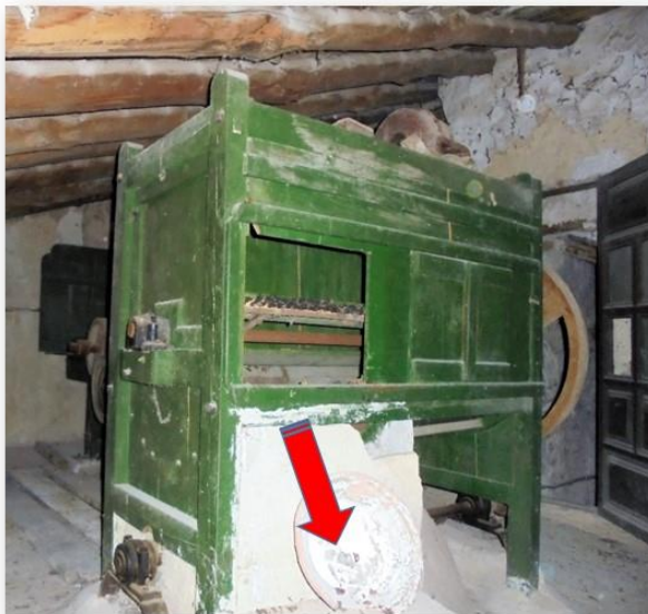
Vertido libre del producto al forjado
