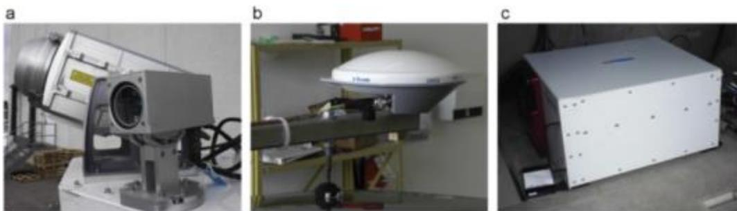
**Fig. 10.** (a) Sensor y cámara Lynx LiDAR; (b) antena GPS Applanix y (c) Unidad de control Lynx.
