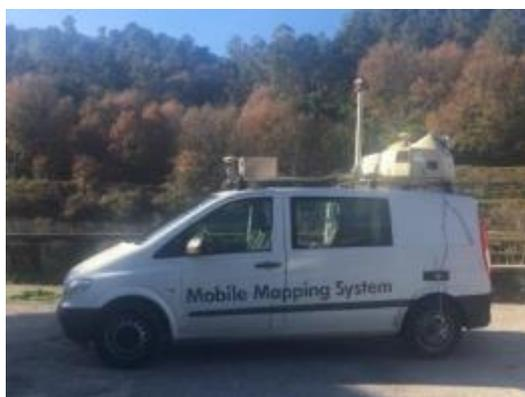
**Fig. 9.** Vehículo de inspección terrestre y LiDAR Optech instalado sobre el techo.
