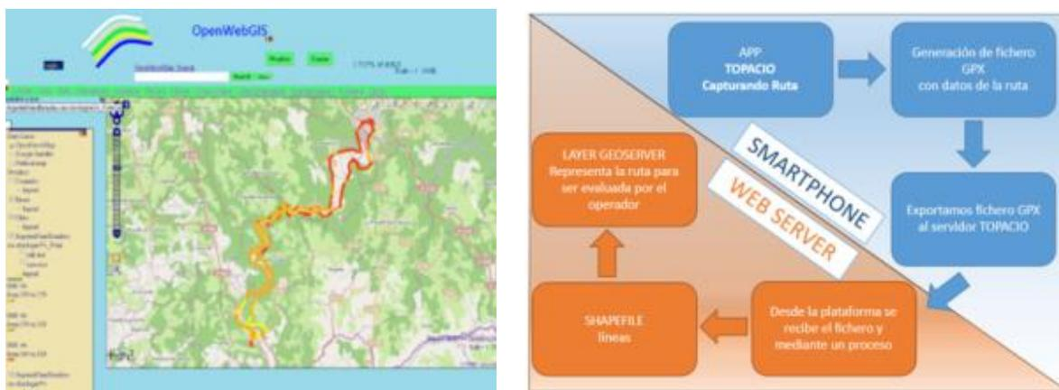
**Fig. 26.** Ejemplo de ruta recogida en un Smartphone y diagrama-resumen de trasposición de datos desde el teléfono al sistema experto de gestión mediante Web Server.
