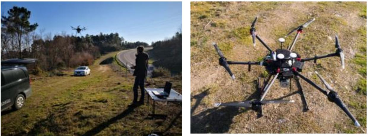
**Fig. 13.** Ejemplo de análisis de la Autovía Ourense-Celanova con LiDAR embarcado en drones: vuelo sobre la carretera (izquierda) y detalle del dron empleado (derecha).
