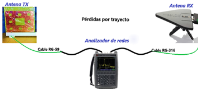
Figura 12. Conexiones para determinar la ganancia de la antena fractal.
