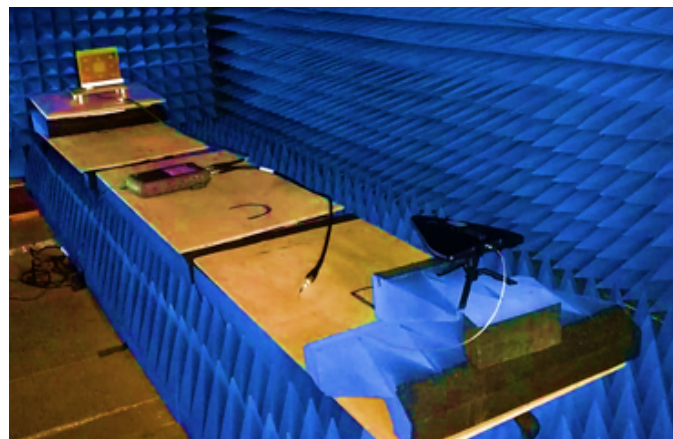
Figura 12. Escenario durante las mediciones de la ganancia de la antena fractal.
