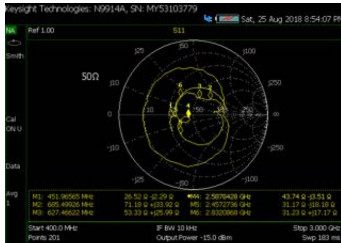
Figura. 11. Mediciones de la impedancia de entrada de la antena fractal alfombra de Sierpinski con puerto de alimentación 2.
