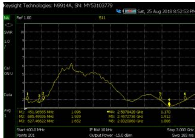
Figura 10. Mediciones del VSWR de la antena fractal alfombra de Sierpinski con puerto de alimentación 2.
