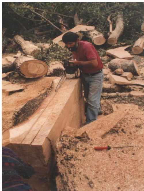
IMAGEN 2 CROSIER CARRASCO EN PROCESO CORTE DE QUILLA
