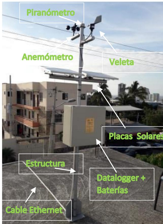
**Figura 5.** Prototipo – Estructura Física de la estación meteorológica automática.
