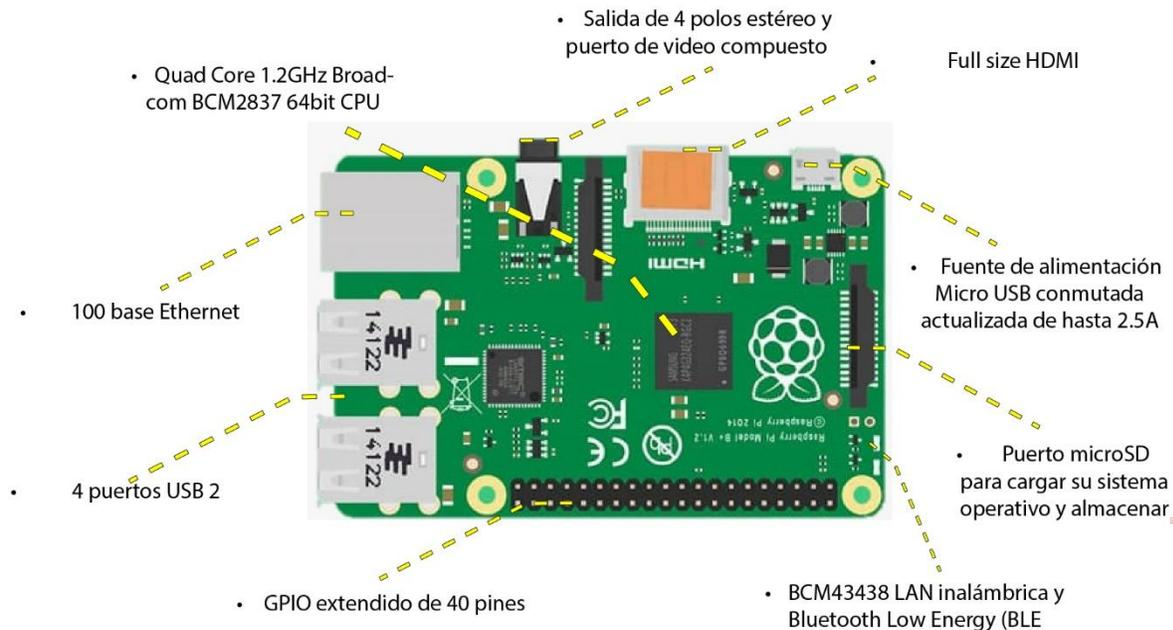
**Figura 6.** Características de la RaspBerry Pi 3 Modelo B.
