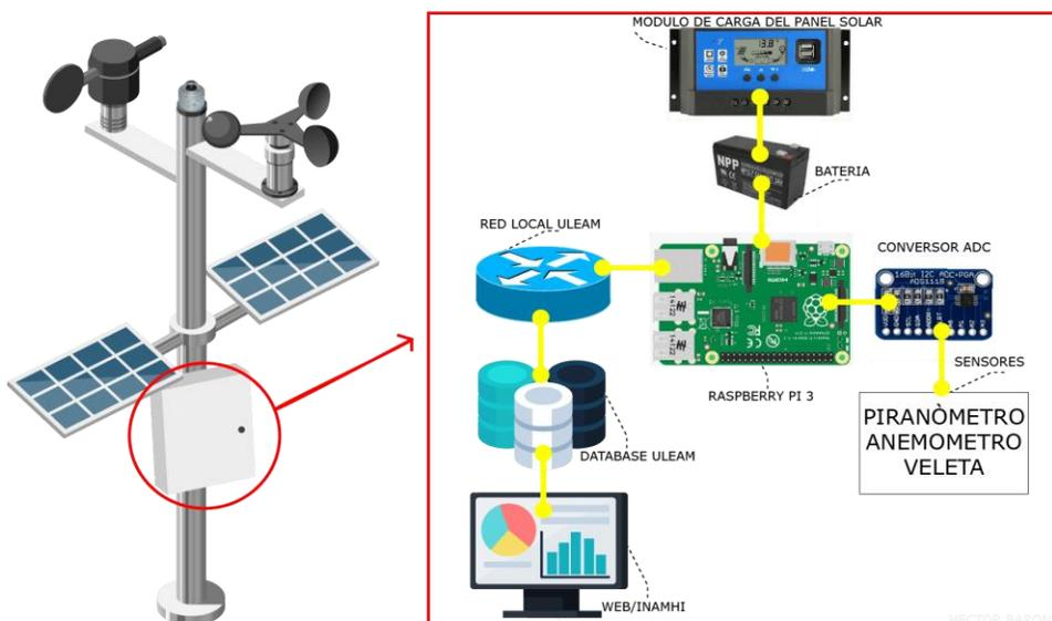
**Figura 4.** Esquema global de la estación meteorológica automática.
