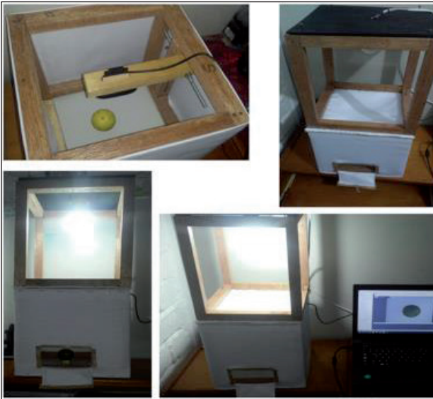
Figura 4: Imágenes Reales del Prototipo de Adquisición de Imágenes de Citrus Aurantifolia.
