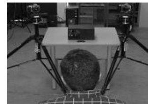
Figura 9. Sistema de adquisición de imágenes 3D Figure 9. 3D image acquisition system
