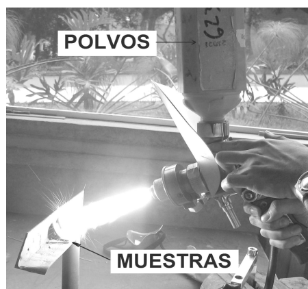
Figura 1. Elaboración de los recubrimientos por proyección térmica por llama
