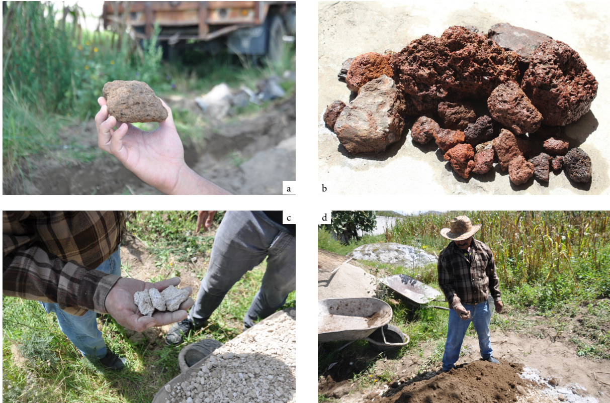
Figura 11. Materiales que componen las tapias, Tepeyahualco, Puebla: a. Piedra “poma”; b. Tezontle; c. Cacahuatillo; d. “Barro renegrido” (Acervo del LABPySCT, María de los Ángeles Vizcarra)
