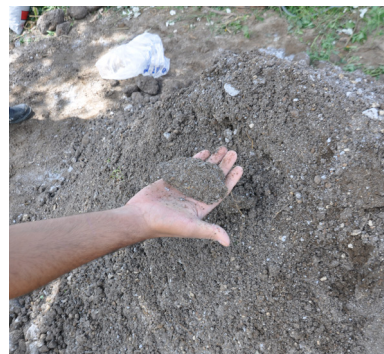
Figura 16. Materiales mezclados: en seco y ya con el grado exacto de humedad, Tepeyahualco, Puebla (Acervo del LABPySCT, María de los Ángeles Vizcarra)
