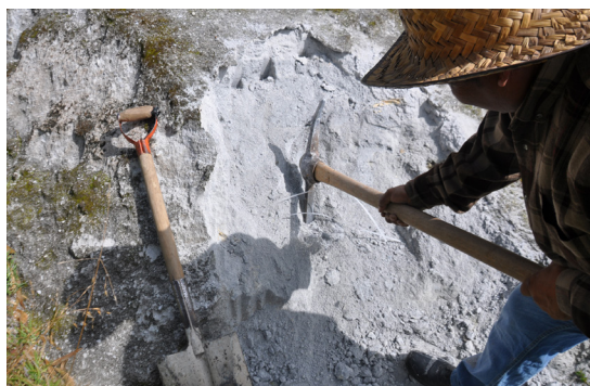
Figura 12. Excedente de cal, Tepeyahualco, Puebla: vista del residuo en la calera y en el sitio de trabajo. En la última imagen, los puntos blancos que se observan son las partículas de óxido e hidróxido de calcio presentes en el remanente (Acervo del LABPySCT, María de los Ángeles Vizcarra)
