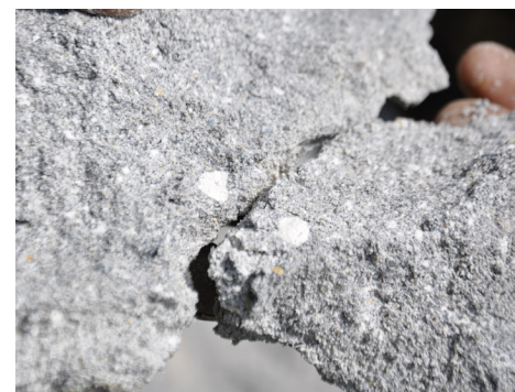
Figura 12. Excedente de cal, Tepeyahualco, Puebla: vista del residuo en la calera y en el sitio de trabajo. En la última imagen, los puntos blancos que se observan son las partículas de óxido e hidróxido de calcio presentes en el remanente (Acervo del LABPySCT, María de los Ángeles Vizcarra)
