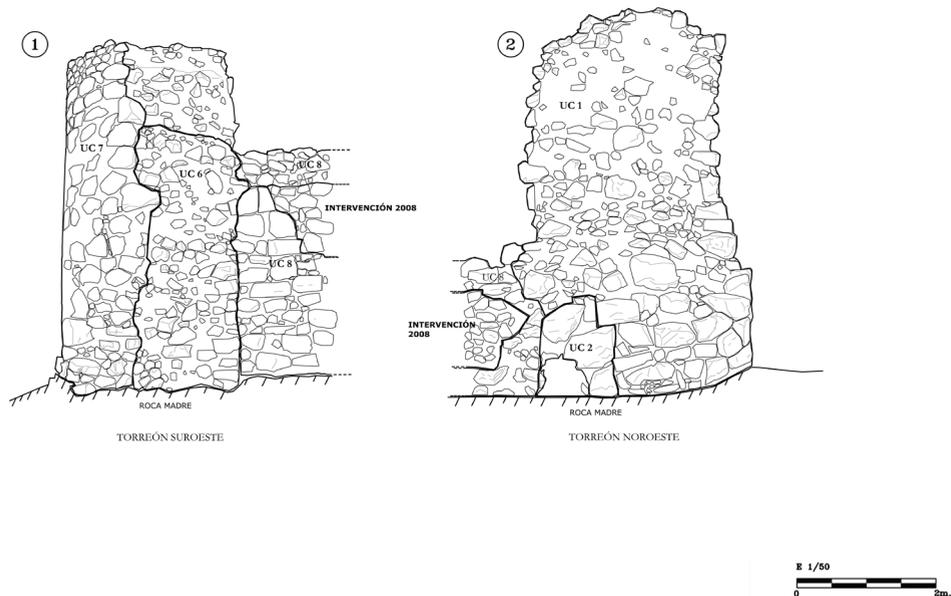
Fig. 7: Alzado de los torreones noroeste y suroeste.
