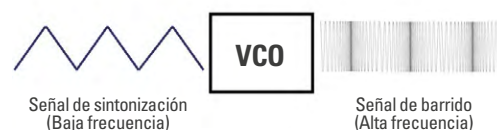
Figura 2. Barrido de frecuencia lineal (LFM)
