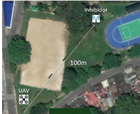
Figura 15. Escenario de prueba GPS L1-100m Fuente: elaborado a partir de imagen de Google Maps (2020).
