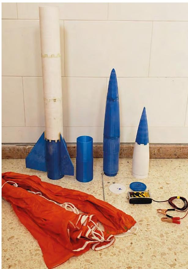
Figura 2. Cohete USB-Rocket Réplica I realizado enteramente con manufactura tipo FDM
