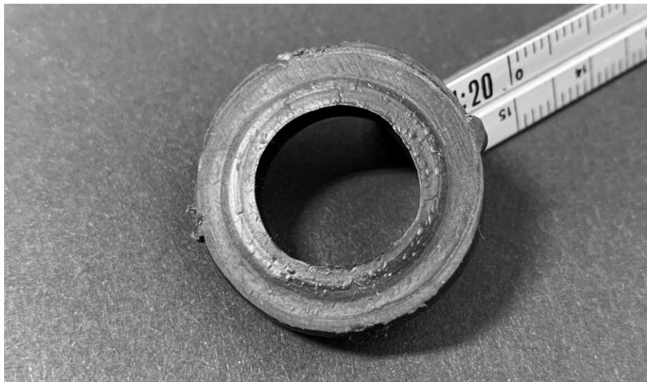
Figura 5. Ejemplo de un empaque de una manguera deformado por efecto de la compresión y por la exposición continua al calor (foto: de los autores).
