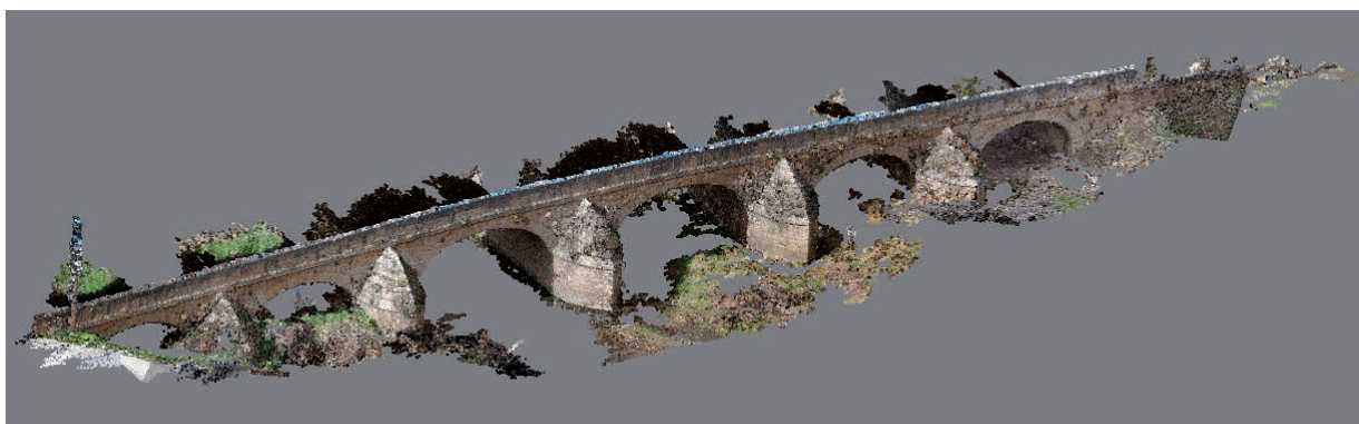
Fig. 10. Modelo del frente aguas arriba del puente de Montejo obtenido con el programa PhotoScan.
