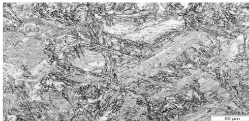
**Figura 2.** Martensita revenida. Acero inoxidable AISI 410 templado a partir de 1000°C y revenido a 200°C durante una hora (MO, 200 X, Ataque: Villela)
