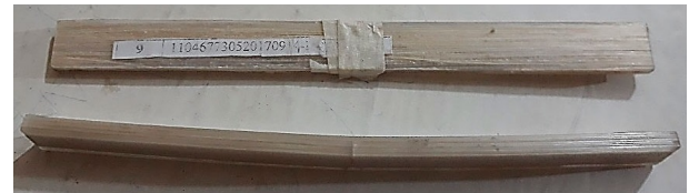
Figura 8. Probetas ensayadas del composite reforzadas con fibra de abacá.
