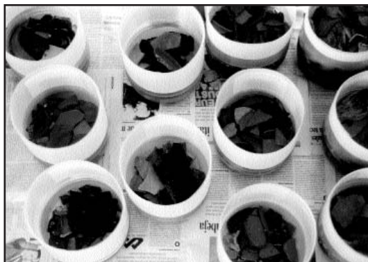
Lámina IX.: Desalinización de cerámicas
