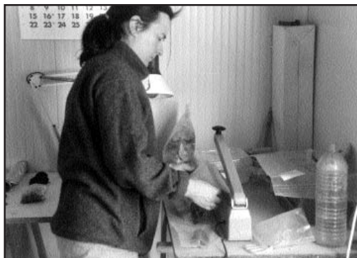
Lámina X: Proceso de termosellado
